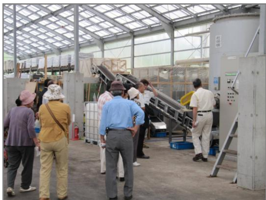
回収された生ごみ(右下のポケット)をグリーン色の自動釣り上げ装置でホッパーに運び、生ごみを投入して粉碎し、やや左中央にある円筒形の乾燥機で乾燥した生ごみを、そのひだりにあるベルトコンベアで振るい機に運び、その後EM(有用微生物群)を掛けて袋詰めし、そのまま45日ほど発酵・熟成させてでき上がる。
