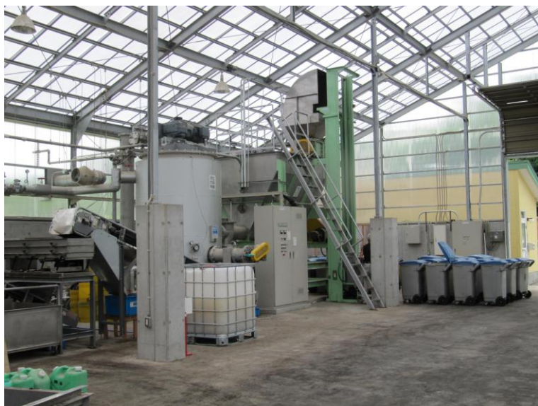
回収された生ごみ(右下のポケット)をグリーン色の自動釣り上げ装置でホッパーに運び、生ごみを投入して粉碎し、やや左中央にある円筒形の乾燥機で乾燥した生ごみを、そのひだりにあるベルトコンベアで振るい機に運び、その後EM(有用微生物群)を掛けて袋詰めし、そのまま45日ほど発酵・熟成させてでき上がる。
