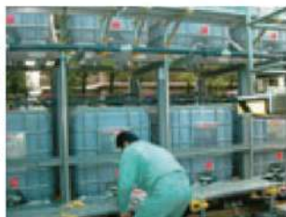
左は一次培養装置。右が二次培養装置。循環用パイプで11タンクが10基連結されています。
